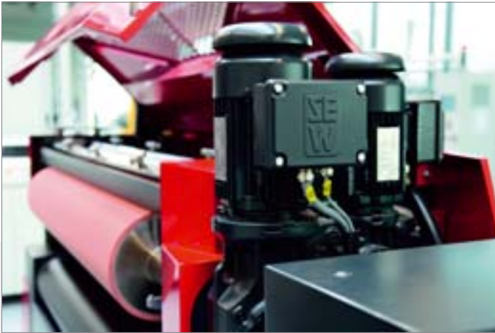
Die Getriebemotoren sorgen für den zuverlässigen und sicheren Antrieb – zum Beispiel in Walzenauftragsmaschine
